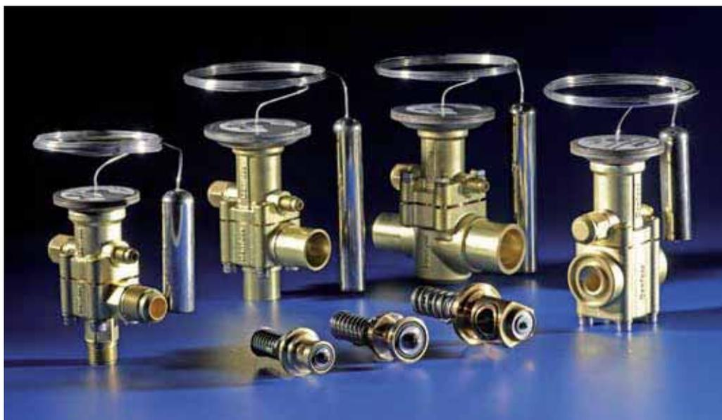
Терморегулирующие клапаны TE регулируют количество жидкого хладагента, поступающего в испаритель холодильной системы в зависимости от перегрева на выходе из испарителя. При производстве силового термочувствительный элемент из нержавеющей
